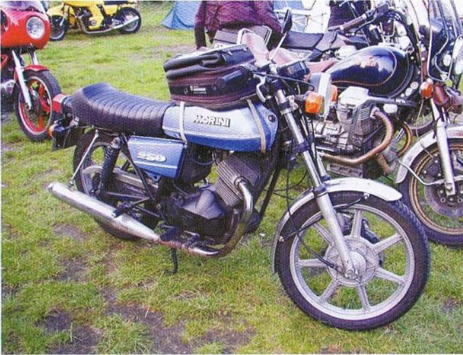
***Moto Morini 250 T. Der Einzylinder-Motor stammt von dem 500er-V2-Triebwerk ab, der hintere Zylinder wurde sozusagen einfach weggelassen.***
